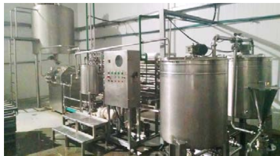
Imagem 4 e 5. Máquinas utilizadas no processamento primário do açaí (De cima para baixo): Areador tipo cilindro, pasteurizador e embaladeira automática.
