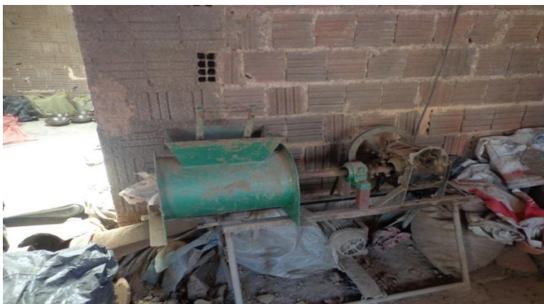
Figura 09- Maromba para compactação do barro.
