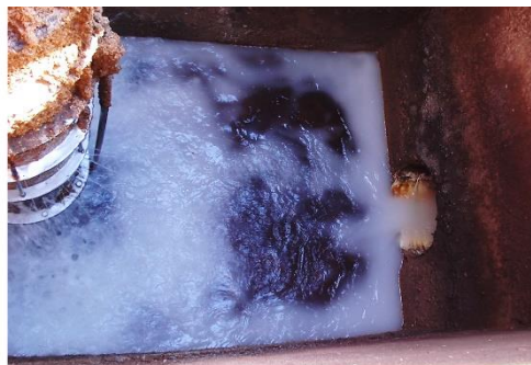
Figura 4 – Manipueira. Efluente industrial do processamento de mandioca. Apresenta aspecto leitoso, cor esbranquiçada ou amarelo-claro e odor forte. Fonte: acervo do CIBiogás.
